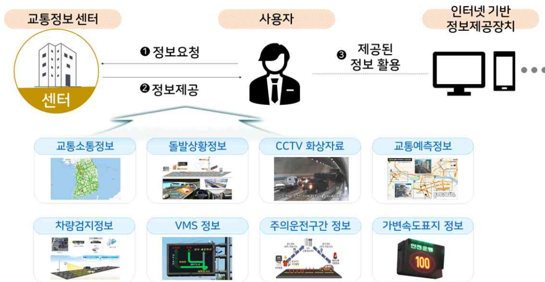
〈그림 17〉 기본교통정보교환 기술기준 III의 정보연계 체계
